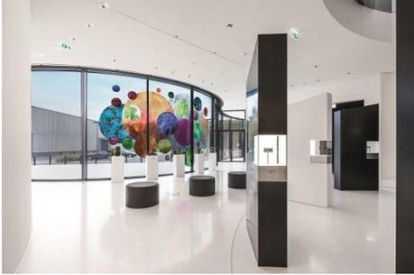
**Bild 4:** Während Zumtobel die Allgemeinbeleuchtung mit den Downlights PANOS infinity mit einer Farbtemperatur von 3000 K realisierte, wurden die Wallwasher aufgrund des Tageslichteinfalls in einer Farbtemperatur von 4000 K eingesetzt.
